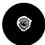
图10 光学元件材料内部存在结石、条纹的星点像图例
