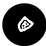
图11 光学元件材料内部存在应力的星点像图例
